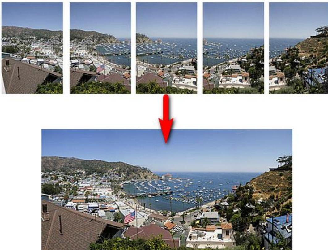
Figure 13 : Exemple de stitching (tiré de [www.arcsoft.com](http://www.arcsoft.com)).
