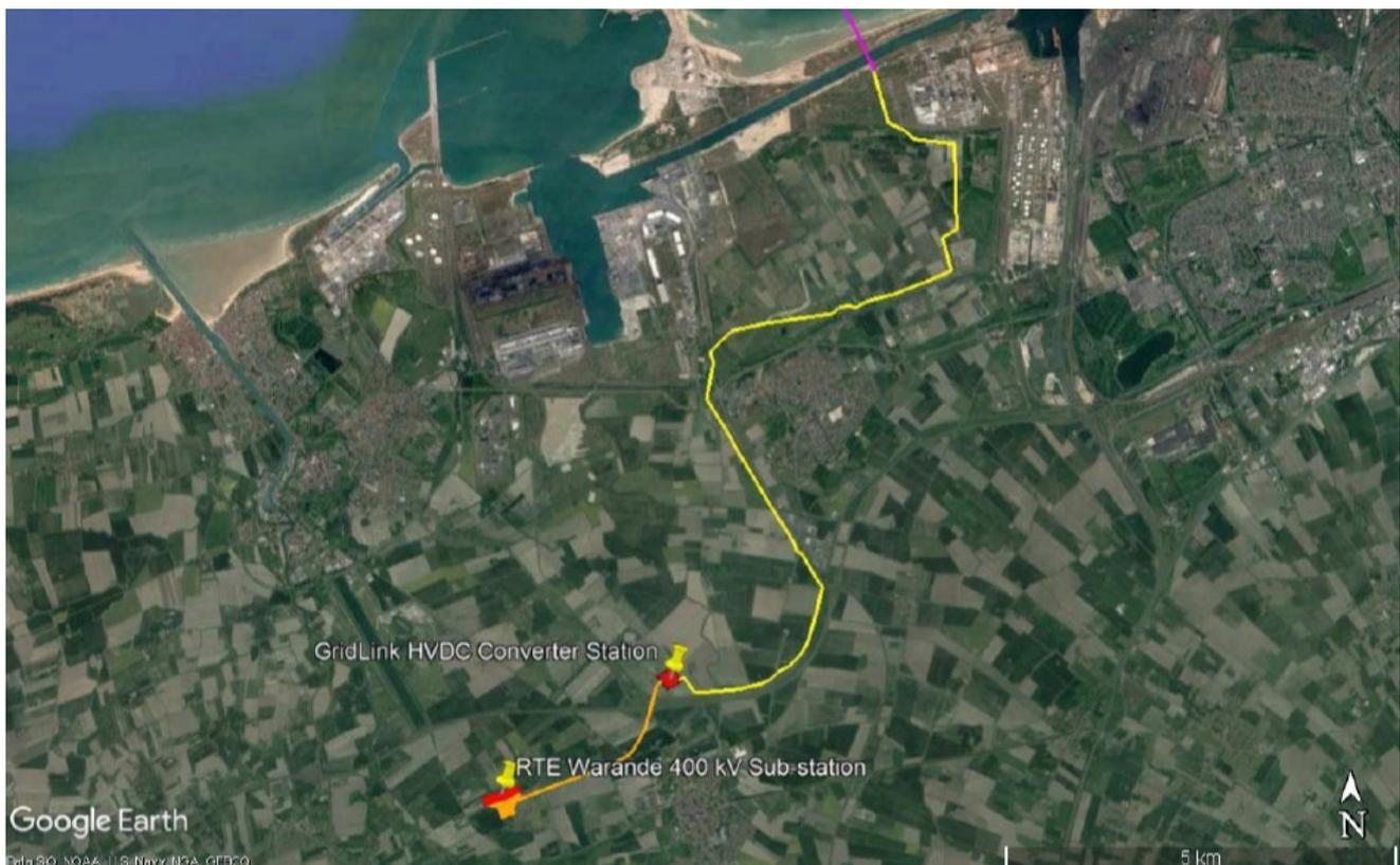
Localisation des câbles sous-terrain, de la station de conversion et du raccordement au poste de Warandé -
