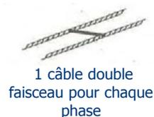
La future ligne à 400 000 volts sera équipée d'un circuit, constitué de trois phases ; chaque phase sera équipée de câbles à double faisceau.
