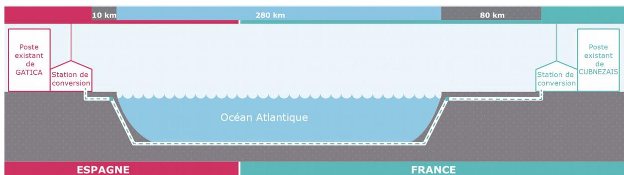
Elle comprendra une station de conversion, à chaque extrémité des 2 liaisons, permettant de transformer le courant continu en courant alternatif et de se raccorder au réseau de transport d'électricité de chaque pays. Le poste de Cubzenais en France a été choisi afin de ne pas avoir à renforcer les lignes existantes.
